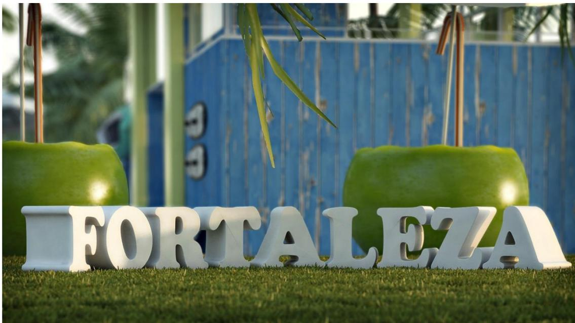
Figura 3 - Nome de Fortaleza em concreto armado com acabamento em poliureia texturizada.
